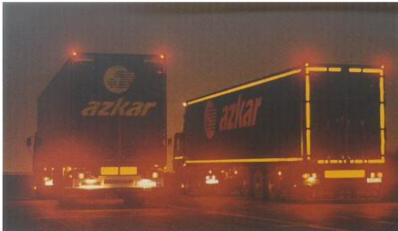
24. számú ábra A kontúrscíkozás láthatóságot fokozó hatása
