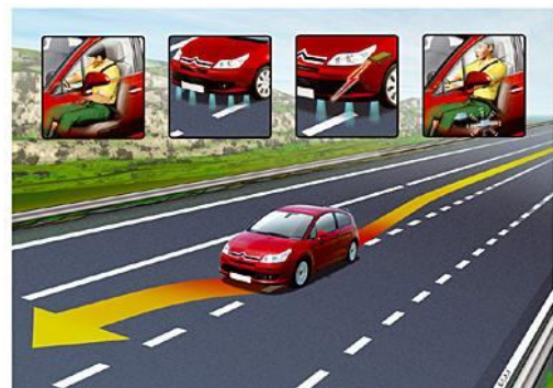
72. számú ábra Véletlen sávelhagyásra figyelmeztető jelzőberendezés 138
