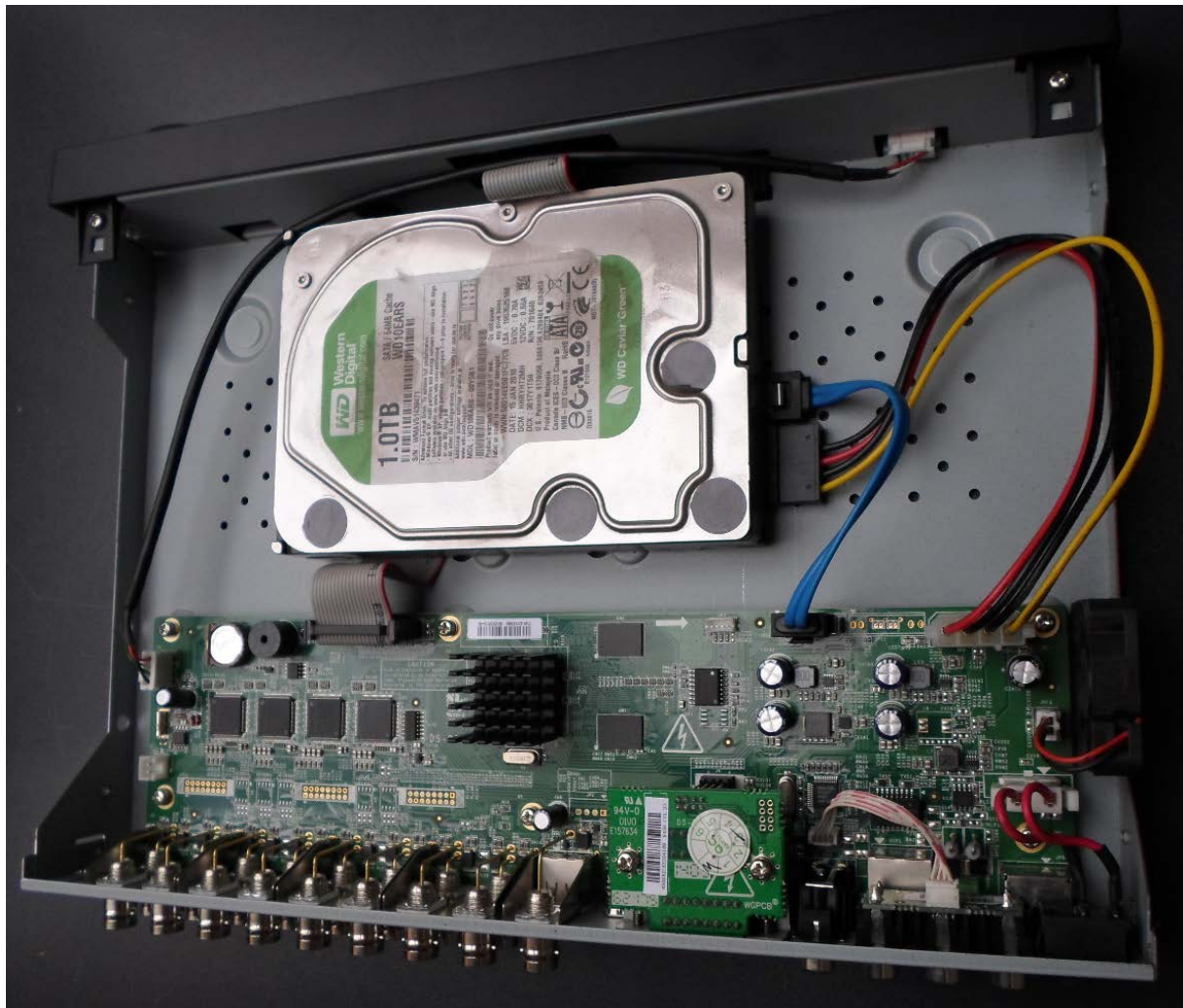
20. ábra - Digitális videorögzítő, megbontott eszközburkolattal 207
