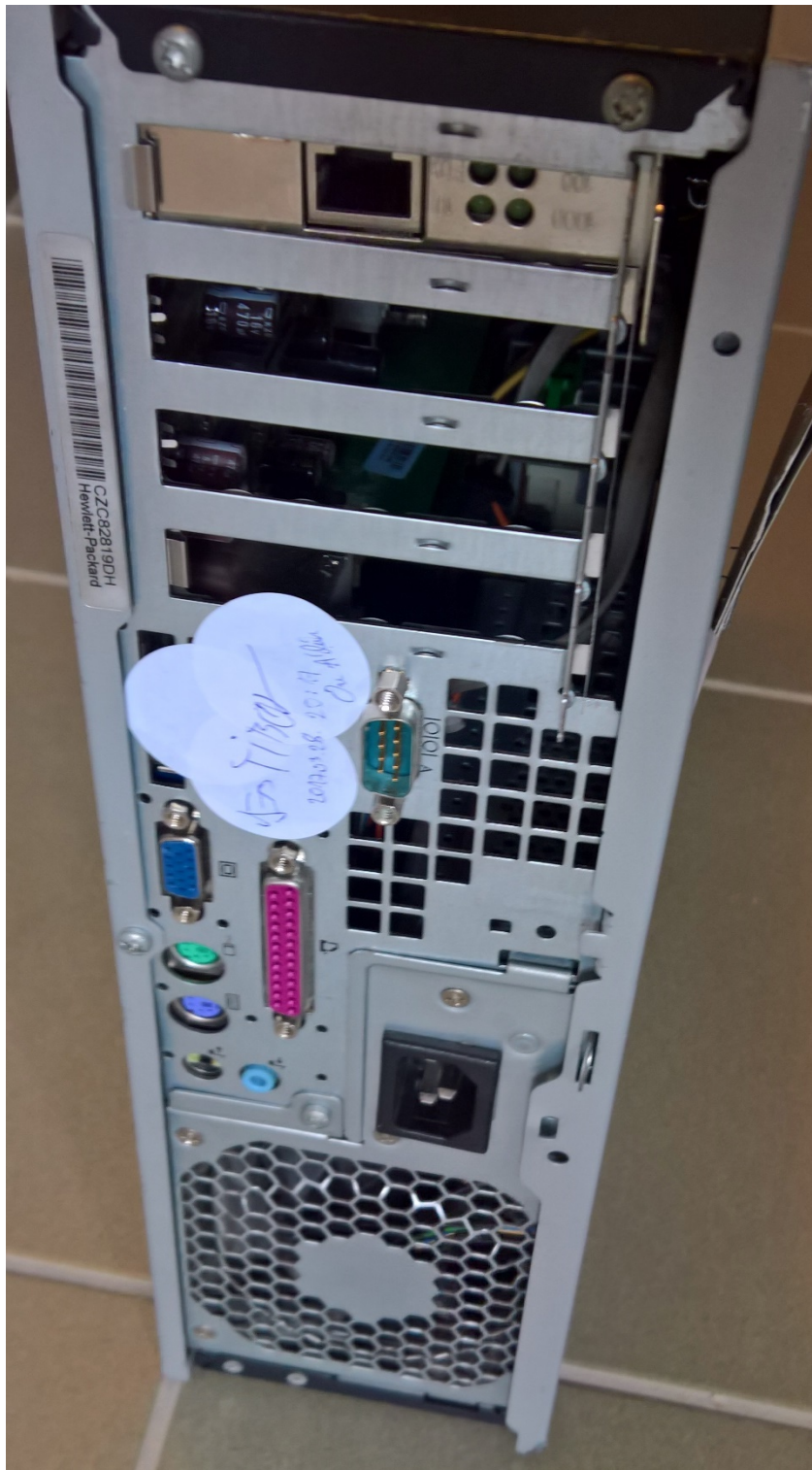
21. ábra - Számítógépház, lezárt csatlakozóval, lezáratlan burkolattal (jobb oldalon középen)
